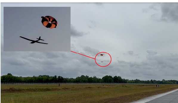
ภาพที่ 3 การลงจอดด้วยวิธี Deep-Stall and Parachute ในช่วงลงจอดด้วยร่มห่วงความเร็ว
