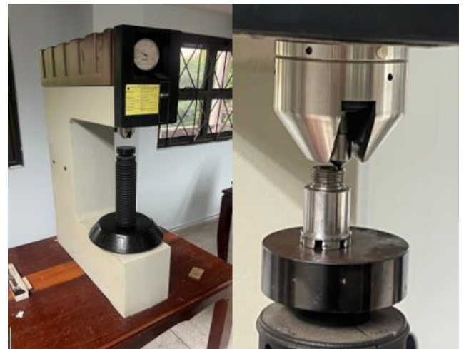
ภาพที่ 3.3 แสดงเครื่องทดสอบความแข็งแบบร็อคเวลล์ที่ใช้ในการทดสอบจริง
