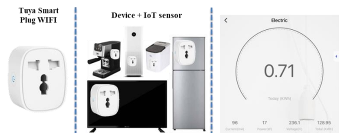
ภาพที่ 1 อุปกรณ์ Smart Plug ที่ถูกติดตั้งกับเครื่องใช้ไฟฟ้าแต่ละชนิด และค่าปัจจัยที่เกี่ยวข้องกับการใช้ไฟฟ้า
