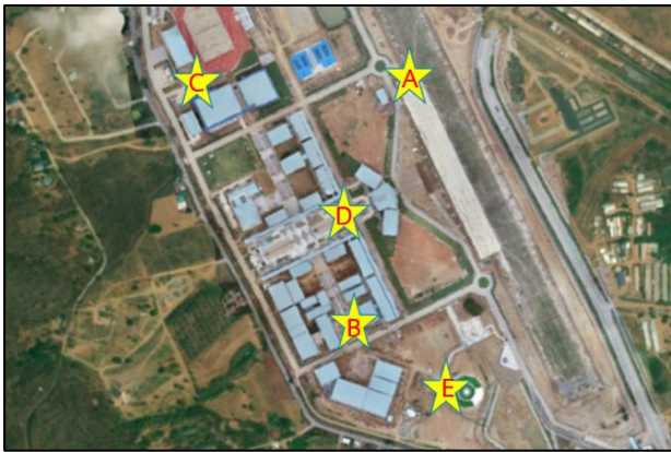
ภาพที่ 5 ตำแหน่งการหาค่าความถูกต้องเชิงตำแหน่งของภาพถ่ายออร์โธในแนวราบ
