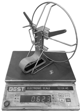
รูปที่ 7 โครงสร้างลำตัวที่เป็นอลูมิเนียม
