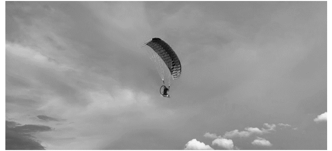
รูปที่ 11 ทดสอบพารามอเตอร์โครงสร้างลำตัว คาร์บอนไฟเบอร์และเพิ่มน้ำหนัก
