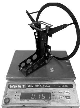
รูปที่ 8 โครงสร้างลำตัวที่เป็นคาร์บอนไฟเบอร์
