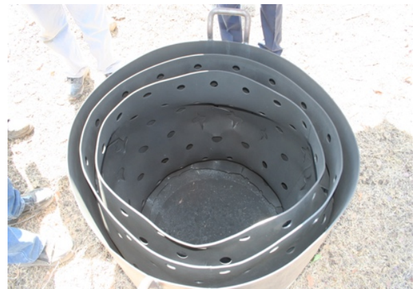
รูปที่ 4.4 ลักษณะการวิบัติที่เกิดขึ้นกับถังเหล็กเปรียบเทียบกับค่าแรงดันที่เกิดขึ้นจากโปรแกรม AIR3D
