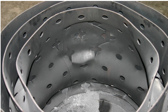
รูปที่ 4.3 ความเสียหายของ T-S-1 จากการทดสอบด้วย ระเบิด TNT 5.0 ปอนด์
