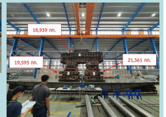
การทดสอบทดสอบสะพานชั้นน้ำหนัก 60 ตัน
