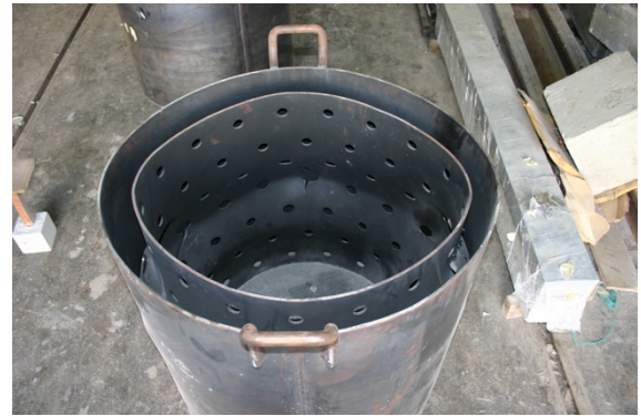
รูปที่ 4.2 ความเสียหายของ D-S-2 จากการทดสอบด้วยระเบิด TNT 4.0 ปอนด์
