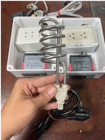
รูปที่ 3.7 แสดงเครื่องควบคุมอุณหภูมิและฮีตเตอร์แบบขด
