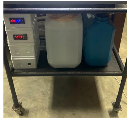
ภาพที่ 3.8 แสดงขั้นตอนการเตรียมสารละลายโดยการผสมน้ำเกลือ (Corro Salt) 5 ส่วน ต่อน้ำ (DI) 95 ส่วนโดยน้ำหนัก
