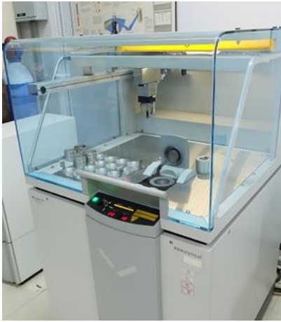
ภาพที่ 3.1 แสดงเครื่องวิเคราะห์ส่วนประกอบทางเคมี (X-ray Fluorescence - WD - XRF) [15]
