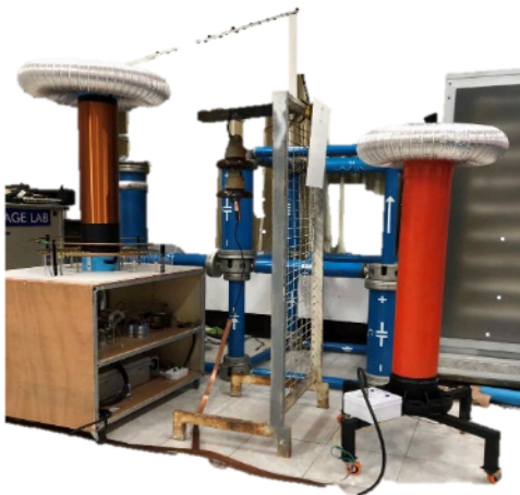
รูปที่ 15 การทดสอบโวลเตจดีไวเคอร์ในการทดสอบลูกถ้วยด้วยหม้อแปลงเทสต่ำ(ทดสอบวัดขณะมีโหลด)
