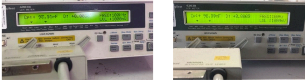
รูปที่ 10 ค่าความจุไฟฟ้าด้านแรงสูงและค่าความจุไฟฟ้าด้านแรงต่ำที่วัดได้จาก LCR Meter Agilent 4263B
