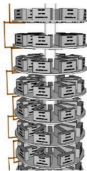
รูปที่ 9 การวางตัวเก็บประจุภาคแรงดันสูงในแต่ละชั้น
