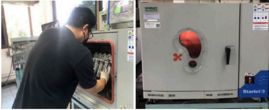
รูปที่ 3 กระบวนการย้อมเส้นด้ายบัวหลวงด้วยเครื่องย้อมแบบอินฟราเรด (Infra-Red (IR) Dyeing machine) ยี่ห้อ Starlet - 3
