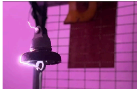
รูปที่ 15 การทดสอบโวลเตจดีไวเคอร์ในการทดสอบลูกถ้วยด้วยหม้อแปลงเทสต่ำ(ทดสอบวัดขณะมีโหลด)
