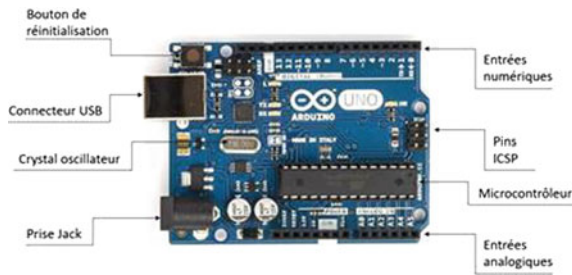
Fig. 4 Arduino UNO card
