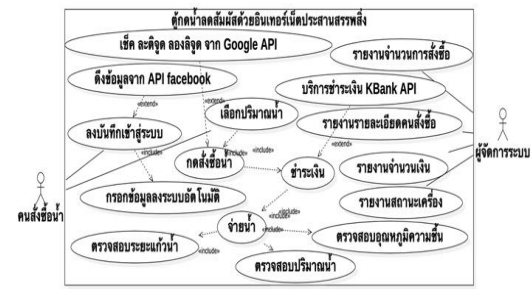
ภาพที่ 1: แผนภาพยูสเคสตู้กดน้ำลดส้ผลิตด้วยอินเทอร์เน็ตประสาน สรรพสิ่ง
