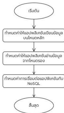
ภาพที่ 6: การตั้งค่าการเชื่อมต่อเว็บแอปพลิเคชันกับฐานข้อมูล
