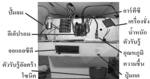
ภาพที่ 5: ต้นแบบตู้กดน้ำลดสัมผัสด้วยอินเทอร์เน็ตประสานสรรพสิ่ง
