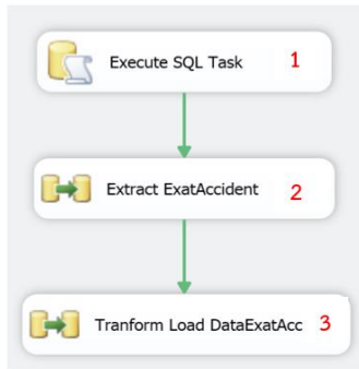
ภาพที่ 3: Control Flow ของกระบวนการ ETL
