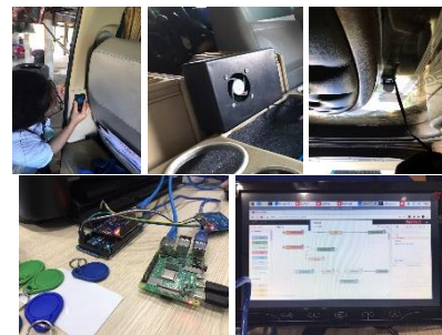
ภาพที่ 2 การติดตั้งอุปกรณ์ในรถ
