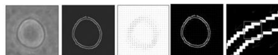
ภาพที่ 7: การค้นหาลักษณะเด่นด้วยวิธีการ HOG
