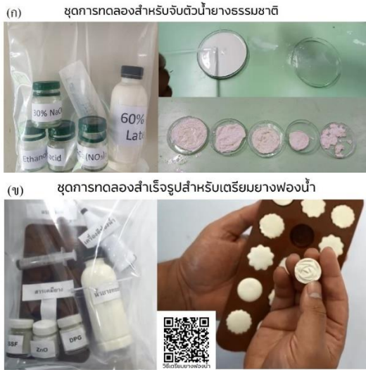
ภาพที่ 2: (ก) ชุดการทดลองสำเร็จรูปสำหรับจับตัวน้ำยางธรรมชาติ (ข) ชุดการทดลองสำเร็จรูปสำหรับเตรียมยางฟองน้ำ
